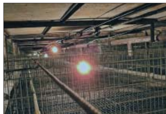
Рис. 3. Клеточное оборудование для выращивания цыплят-бройлеров с использованием в качестве локального освещения ламп накаливания
