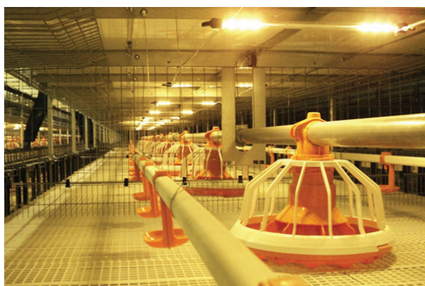
Рис.2 Система локального светодиодного освещения в клеточном оборудовании для откорма бройлеров. Максимальный уровень освещенности на кормушках не менее 120 лк.
