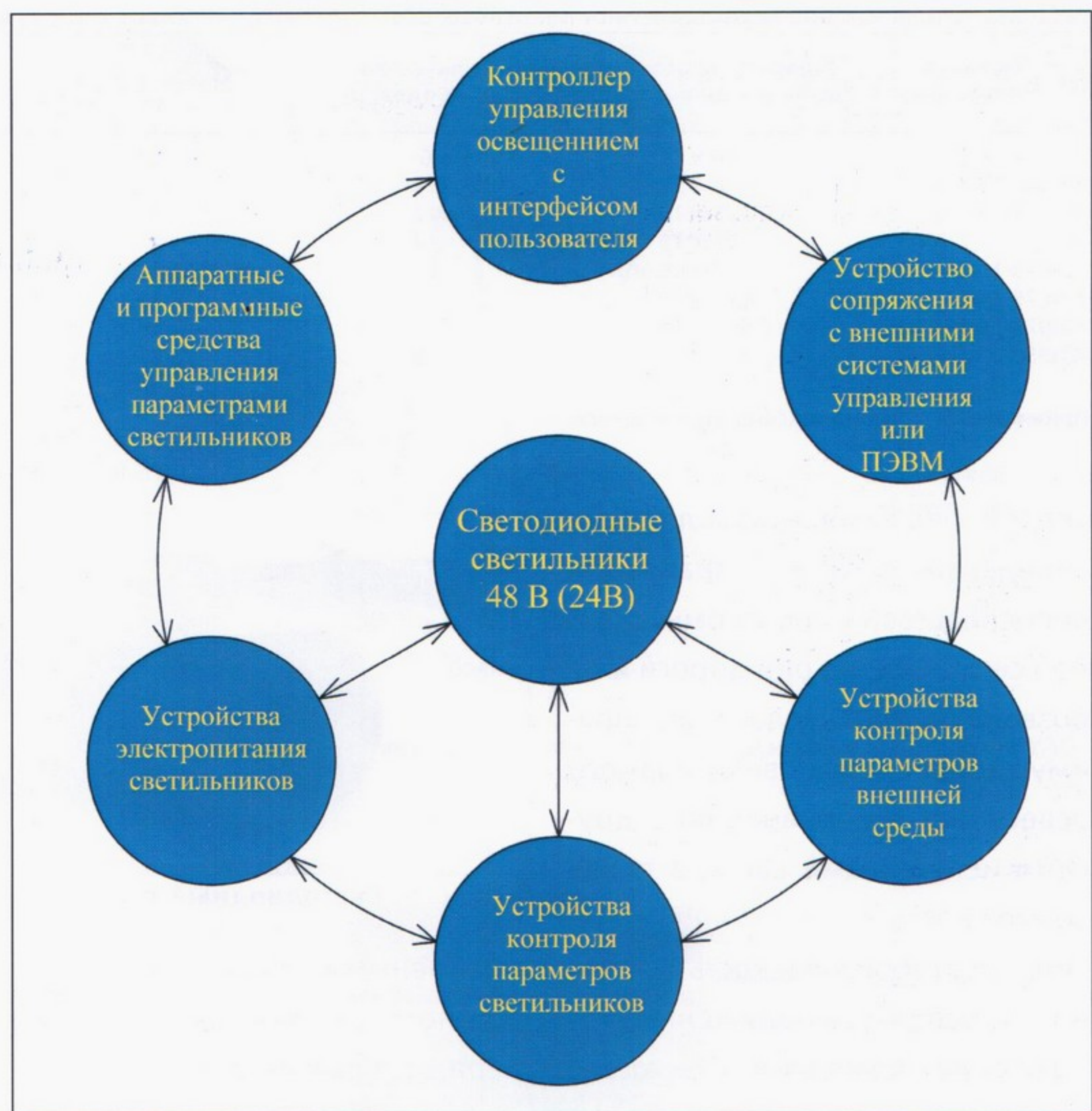
Рис. 4. Структура системы светодиодного освещения «Хамелеон» компании «Техносвет Групп»
