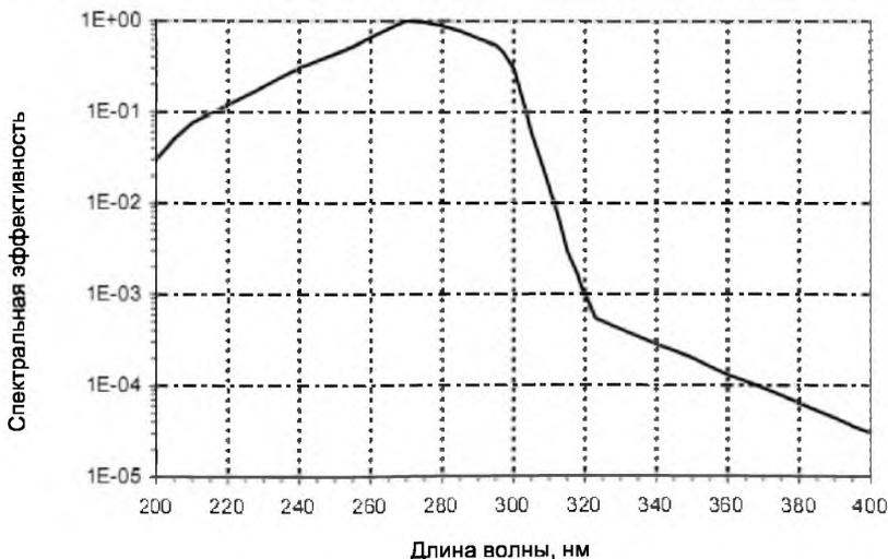
Рисунок 4.1 – Спектральная весовая функция актиничной ультрафиолетовой опасности  $S_{UV}(\lambda)$
