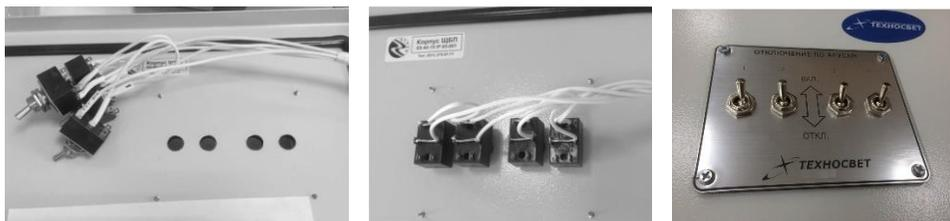
Рис. №2 Крепление тумблеров на лицевую панель блока сопряжения
